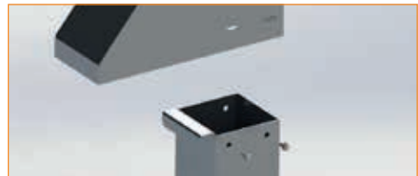
Bild 19 Fixieren des Deckels am FDD mit mitgeliefertem Schraubensatz
